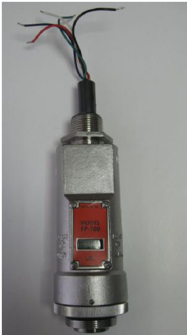
Рисунок 1 – Датчик стационарный термокаталитический FP-700 (без монтажной коробки)
